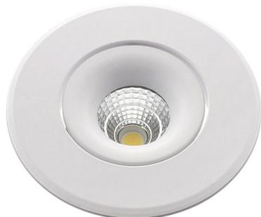
Luminaria LED de alta potencia (12W) con función de emergencia. Puede funcionar como luminaria normal (1200lm) y como luz de emergencia (400lm). Para empotrar en techo. 60 minutos de autonomía con su batería recargable de Ni-Cd. Luz para señalización de salidas, puertas, ascensores, zonas de paso o comunes.
