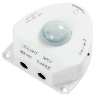
Sensor de movimiento y luminosidad de superficie con múltiples opciones y de muy fácil instalación y uso. Dispone de una innovadora tecnología de detección con sistema IR. Soporta una carga de DC5-24V y 4A. Con reguladores de intensidad de luz, tiempo de encendido y luminosidad. Rango de detección 100º y una distancia de 6m.
